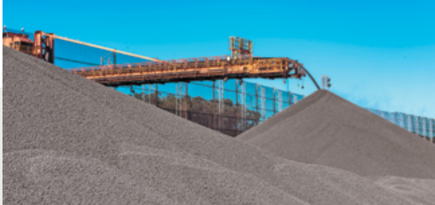
Pelotas de minério de ferro produzidas no Complexo de Ubu da Samarco, em Anchieta (ES); o processo é fundamental para diminuir desperdícios e emissões de carbono
