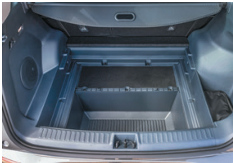
Quanto ao volume para a bagagem, o porta-malas oferece 461 litros (no padrão de medição VDA) até a altura dos encostos traseiros e pode levar até 1.877 litros com o rebatimento dos bancos
