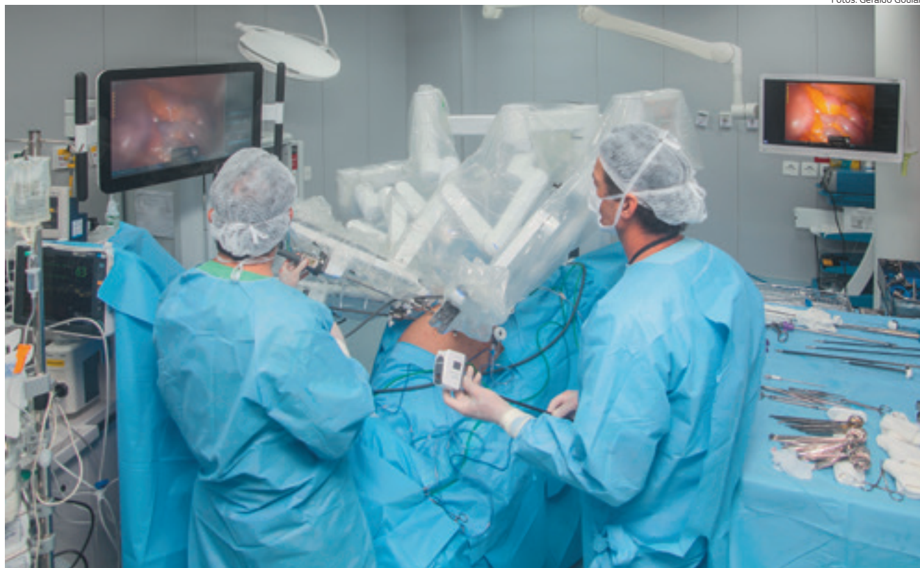
O Da Vinci X, no Biocor, que custa em torno de R$ 16 milhões: braços robóticos reproduzem, com fidelidade e estabilidade, cada gesto do especialista, proporcionando articulações finas, ampla liberdade de movimento e eliminação de tremores.
