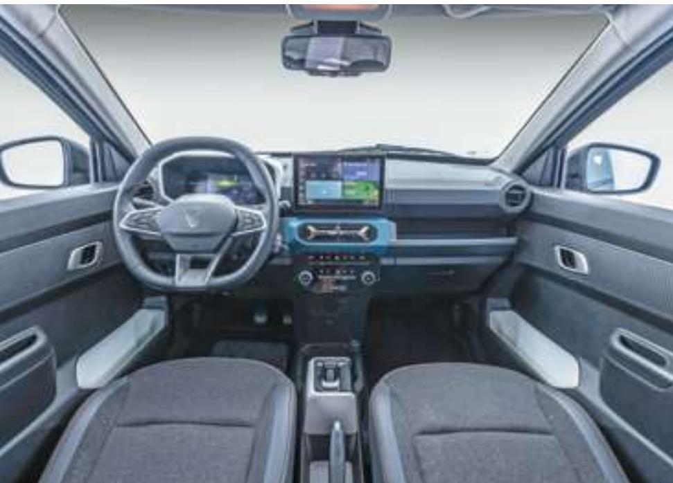
O novo Kwid E-Tech conta com um painel de instrumentos digital e personalizável de 7” e a multimídia de 10”: para otimizar a ergonomia e praticidade, a multimídia foi instalada na posição mais alta possível
