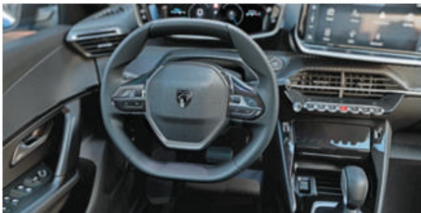
Design interno: volante Sport Drive, de menor diâmetro que o usual e base achatada, chama a atenção e torna mais fácil e agradável a manobrabilidade
