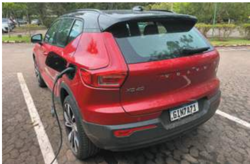
A anunciada autonomia de 418 quilômetros do XC40 "recharge pure electric" foi comprovada nas voltas que demos pelos arredores de Belo Horizonte: no nosso modo de condução a autonomia foi de 437,5 km, comprovando o dado divulgado do fabricante
