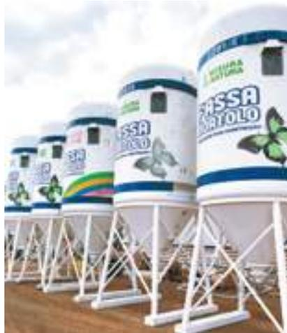
Os silos que podem ser instalados em canteiros de obra: equipamento permite o bombeamento vertical da argamassa e posterior jateamento sobre superfícies, eliminando entrega de sacos
